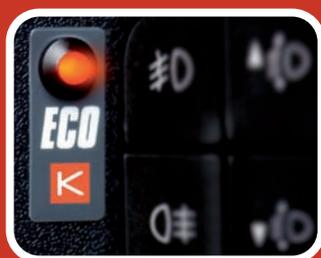
Avec le LED allumé, la puissance du moteur est réduite.
